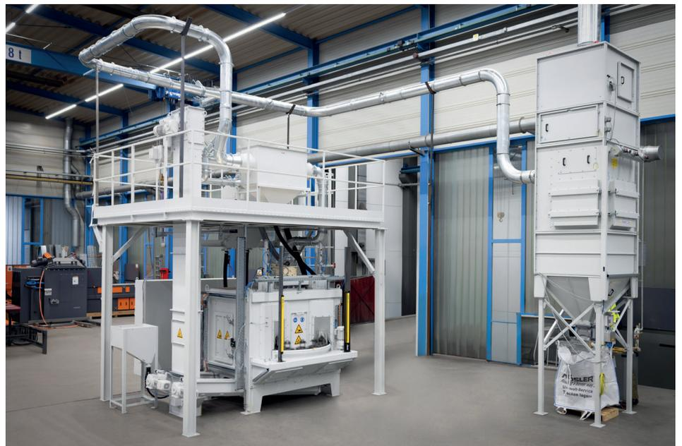
Pie de foto: La granalladora cíclica con satélites RST 200-S15 se ha diseñado para el shot peening de los distintos engranajes en ciclos de corta duración. La plataforma de inspección de grandes dimensiones permite acceder cómodamente a los componentes del sistema de tratamiento y transporte de la granalla, así como al panel de control.
