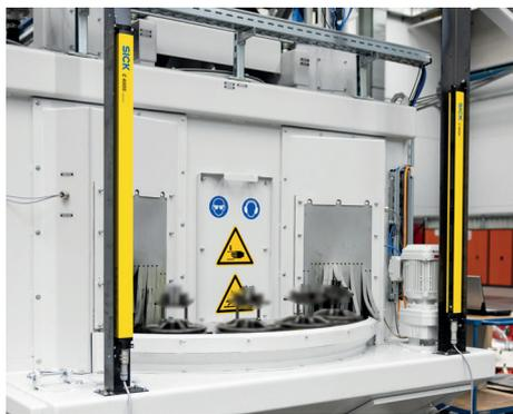
**Pie de foto:** En el plato giratorio hay 15 satélites equipados con alojamientos para las piezas de trabajo que, mediante un sistema de carga y descarga del sistema, lo va alimentando de forma automática. El transporte de las piezas se lleva a cabo en ciclos de 20 segundos.
